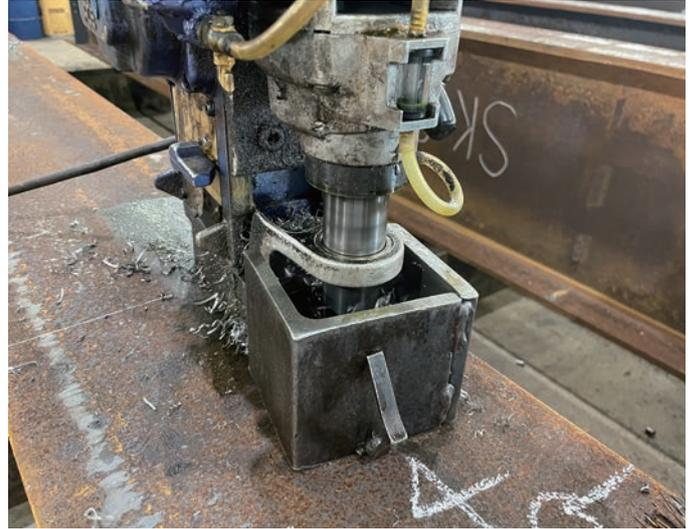
鋼材のご指定場所にキリ穴を開けます。アトラーにてΦ18～Φ50mmまでの穴開け加工が可能です。
