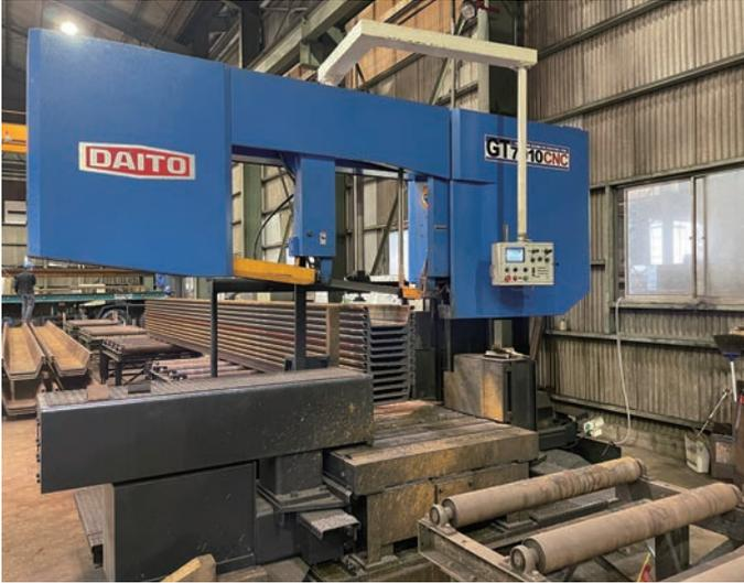
バンドソーにて鋼材をご要望の長さにて切断します。サイズは W=1,000mm H=100mm L=21.0Mまで対応可能です。
