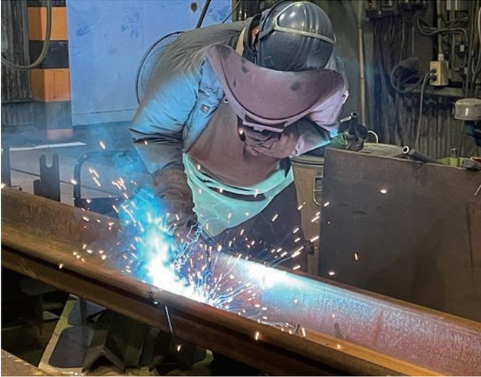
鋼矢板やH形鋼を中心に、継ぎ加工や補強プレートの取り付けなど様々な溶接加工が可能です。
