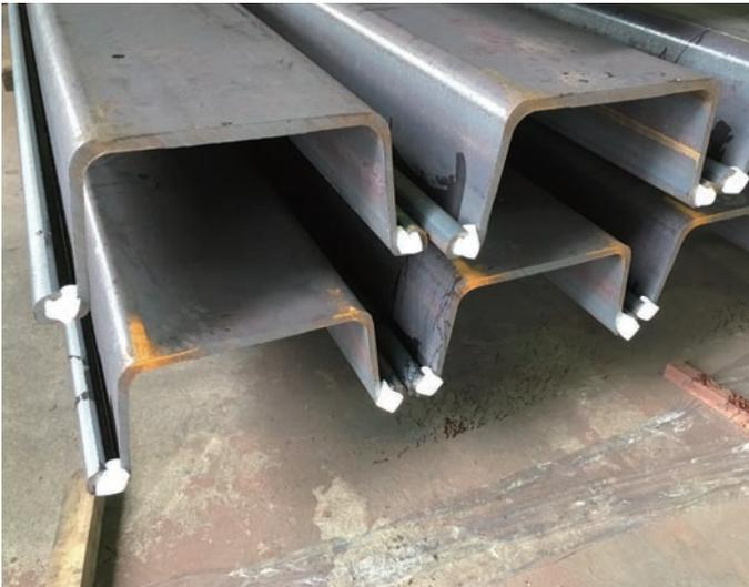
鋼矢板の止水性を更に高めるために、パイルロックを塗布します。現場での加工は養生や塗布の管理が困難になるため弊社の工場内にて熟練の技術者が塗布いたします。
